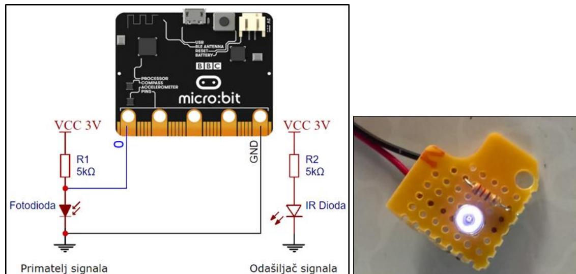
Kod svjetlosnih vrata koristi se infracrvena dioda, elektronički uređaj koji emitira svjetlost u infracrvenom elektromagnetskom spektru. Bijela IR dioda emitira svjetlost, a plava fotodioda detektira. Postav je sličan kao i kod prve metode, ali se koriste samo jedna vrata. Diode
